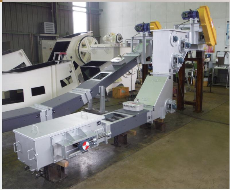
ハコベヤ専用のプレートリンクチェーンを使用した、密閉構造のクリーンな搬送コンベヤ。特に粉体や粒体の搬送などに適しています。
