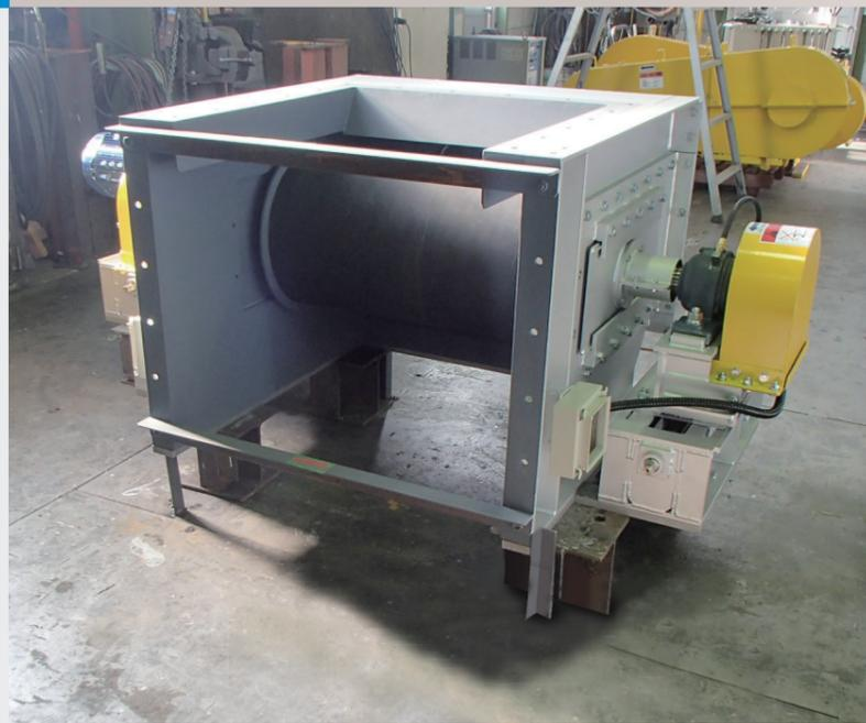
灰ピットの貯蔵率上昇に効果的な、灰を放出・分散させる機器です。
