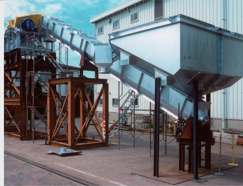
定量搬送性に優れたコンベヤ。密閉搬送や傾斜レイアウトの他に水封式や水冷冷却機能を備えたコンベヤも対応可能です。
